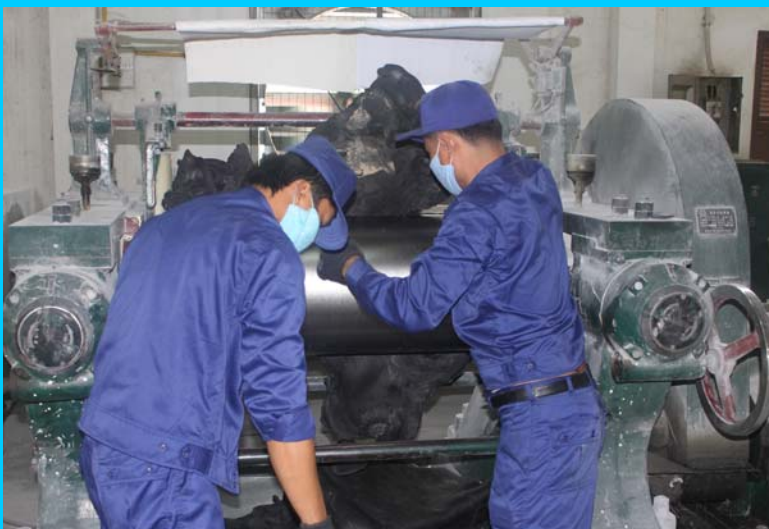
ເຄື່ອງຈັກປະສົມຢ່າງພື້ນເກີບດ້ວຍບັນດາທາດປະສົມຕາມມາດຕະຖານສາກົນ.
